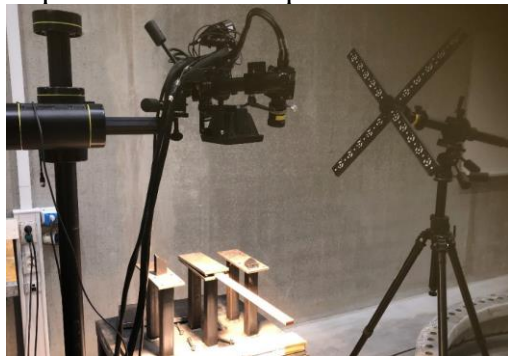
Composite F2 DIC set up
