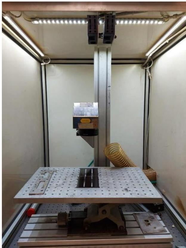
Fig. 59 – Laser in fibra di itterbio
