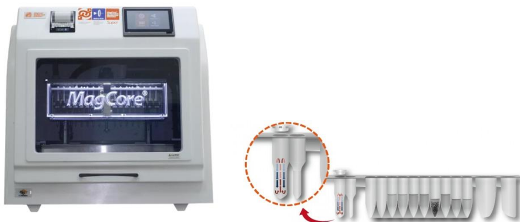
Fig. 20 – Estrattore automatico MagCore™ (sinistra); schema delle cartucce che vengono caricate sull'estrattore (destra). Sono allungate e organizzate in piccoli pozzetti, ognuno contenente una soluzione diversa. Durante la procedura di estrazione, lo strumento fora la pellicola che ricopre la cartuccia e, tramite l'apposito puntale, utilizza il contenuto dei vari pozzetti a seconda del protocollo di estrazione.
