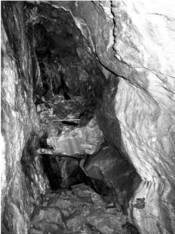
fig. 5 – Usseglio, miniera del Masòc, livelli sovrapposti separati da ripiena armata (foto Maurizio Rossi 2012).
