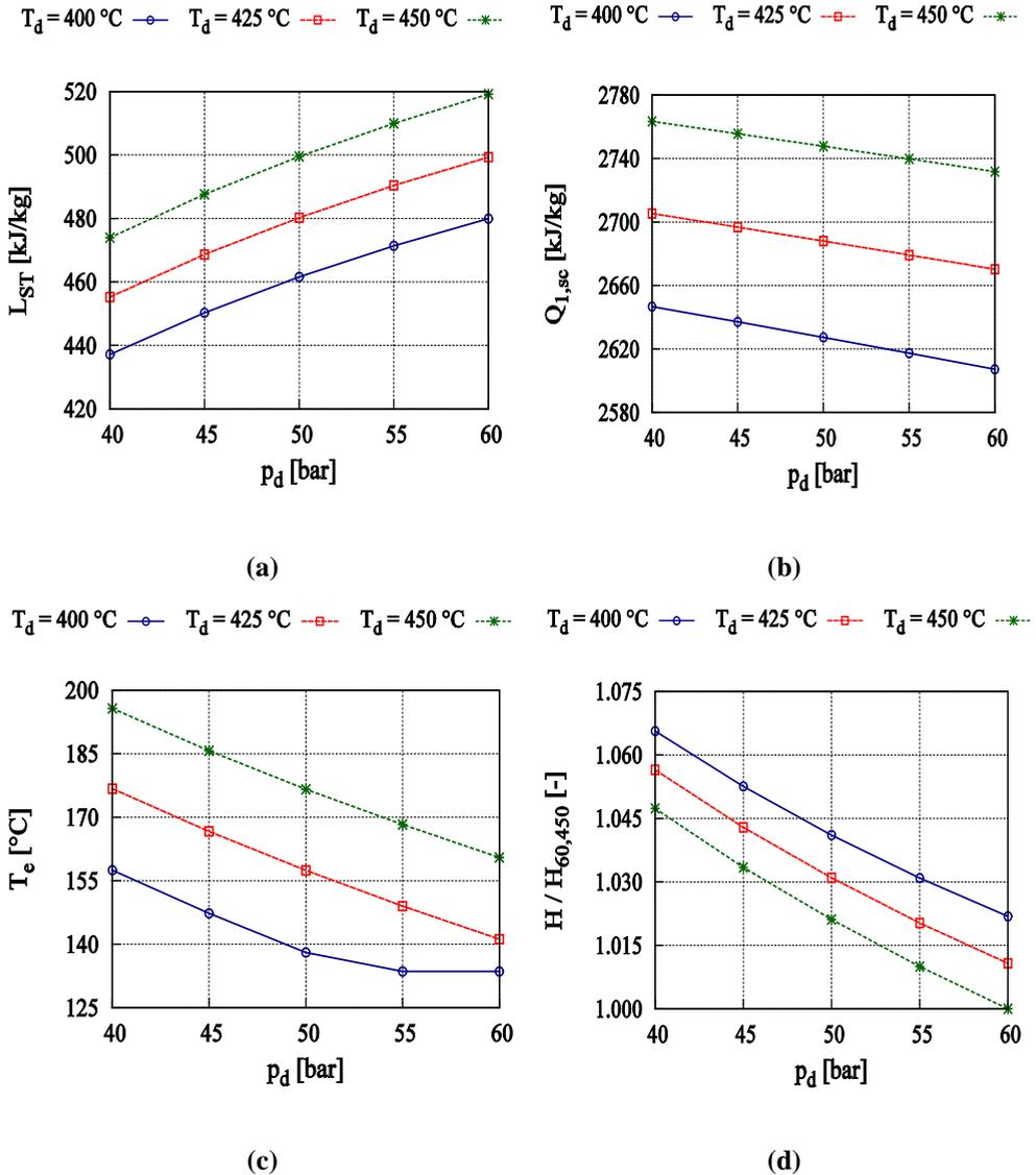
**Fig. 2.** Influence of  $p_d$  and  $T_d$  on: (a)  $L_{st}$ , (b)  $Q_{1,sc}$ , (c)  $T_e$ , (d)  $H/H_{60,450}$
