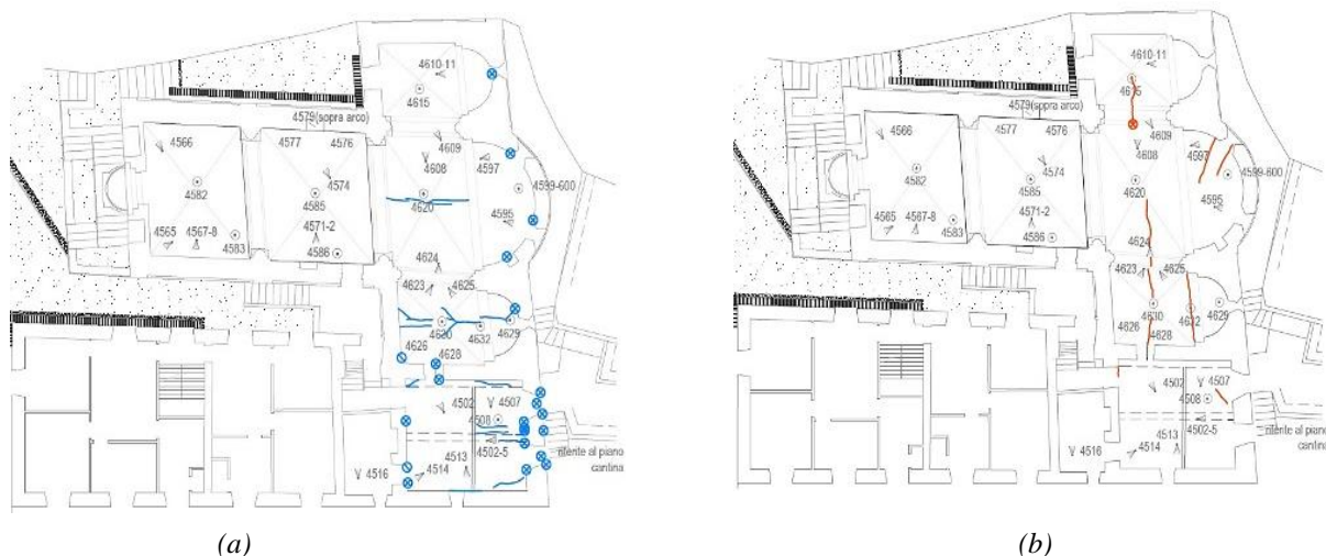
(a) (b) Figura 6 - Rilievo del quadro fessurativo nel complesso di San Nicolò
