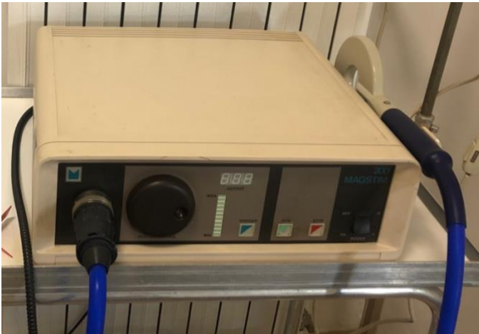
Figura 2. Generatore Magstim 200 (Magstim Co. Ltd, Whitland, UK) associato ad una bobina circolare.
