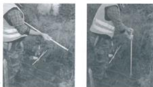
Figura 6. Sensore allocato in un tubo in PVC (a sinistra) ed inserimento in foro verticale precedentemente realizzato (a destra).
