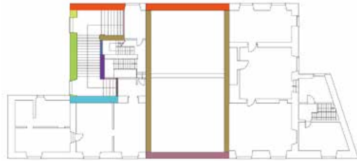
Fig. 21 – Individuazione dei diversi tipi di muratura dell'involucro opaco al Piano Ammezzato.
