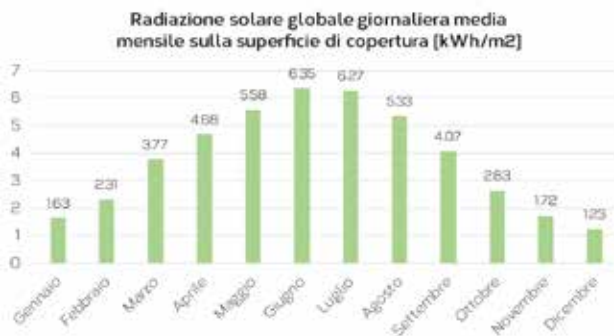
Fig. 9 – Radiazione solare sulla superficie di copertura.
