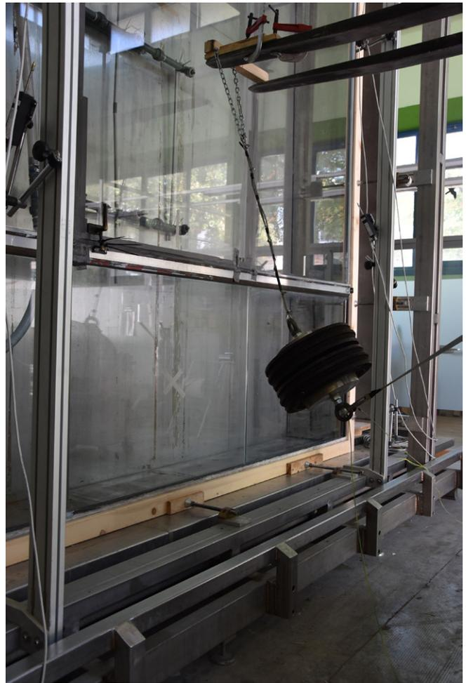
Fig. 4. San Michele all'Adige (Trento), prova d'urto sul vetro temperato presso il Laboratorio CNR IBE specializzato su serramenti e facciate continue (foto M.P. Repetto 2023).
