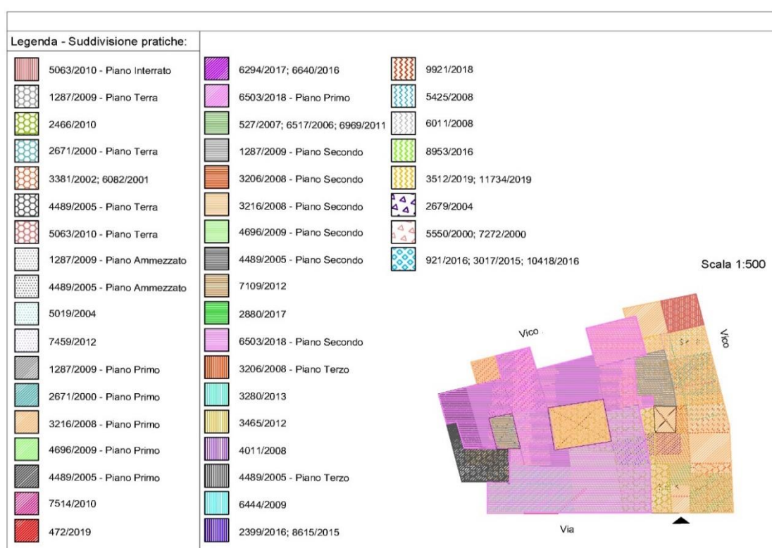
Figura 8 – Esempificazione della complessità della stratificazione degli interventi eseguiti in un civico del centro storico, ricostruiti attraverso l'esame delle pratiche edilizie a seguito del progetto Rollindagando.
