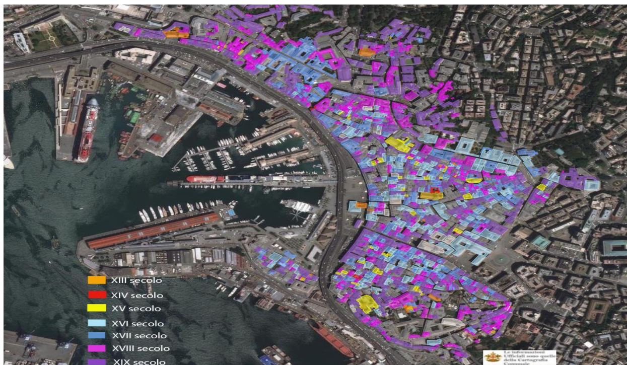
Figura 6a, Epoca prevalente, intendendo con essa quella che connota nel suo insieme l'edificio a prescindere da preesistenze e inserimenti successivi;
